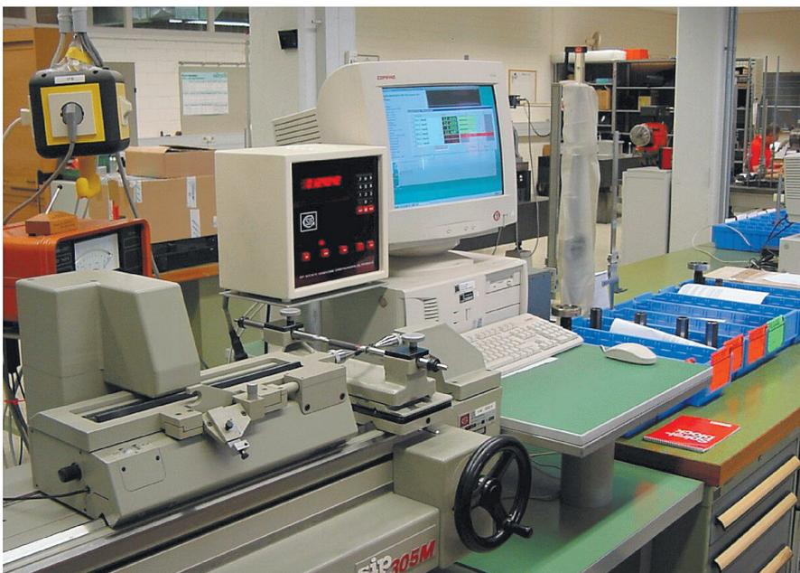
Bild 1. Werkzeug-Messcenter bei Mann + Hummel mit EiQMI-Arbeitsplatz
